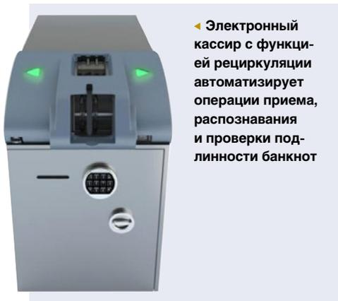
Электронный кассир с функцией рециркуляции автоматизирует операции приема, распознавания и проверки подлинности банкнот
